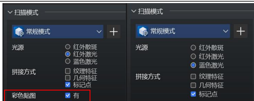
图 7-14 蓝色激光-标记点和红外激光-标记点设置界面对比
