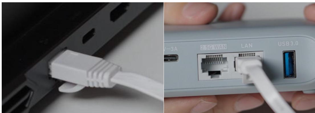
图 3-4 路由器网线连接示意图
