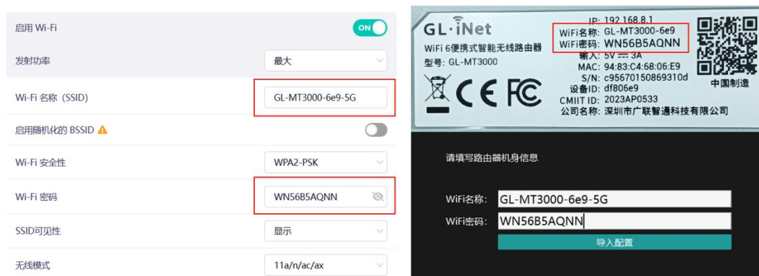
图 4-5 路由器登录界面 (左)、路由器铭牌 (右上) 和软件界面 (右下) WiFi 信息示意图
